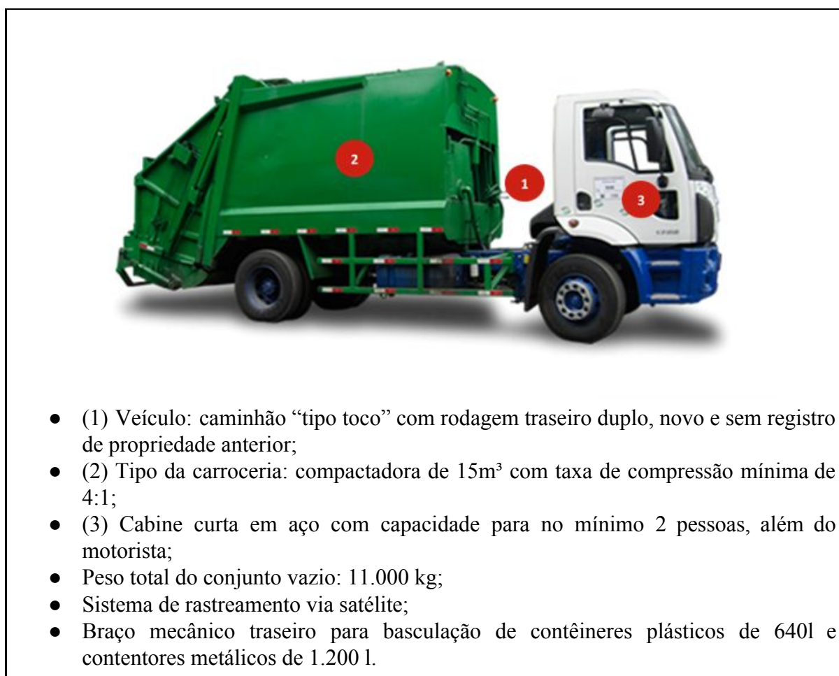
Figura 32 - Características básicas recomendadas do veículo para coleta de rejeitos (Canal Cinza)
