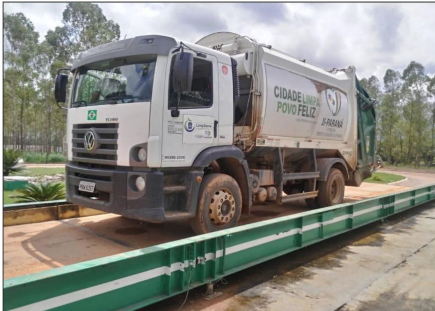
Figura 11 - Caminhão compactador (coleta de rejeitos) Fonte: Secretaria Municipal de Meio Ambiente (2020)
